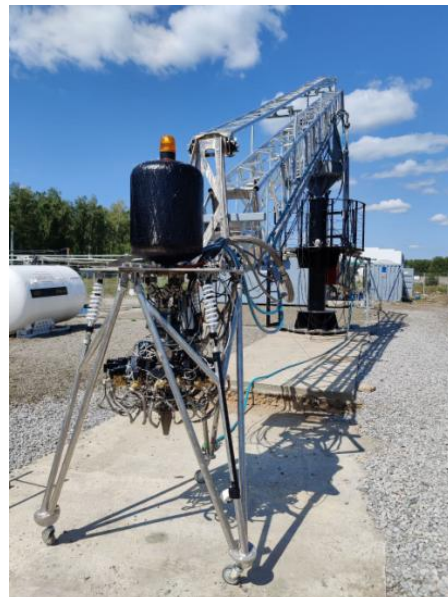
Рис. 2. Первый в РФ полноразмерный стенд для демонстрации сложного управляемого движения ДУ с ЦТ в пространстве. Продемонстрировано движение демонстратора двигательной установки в пространстве
