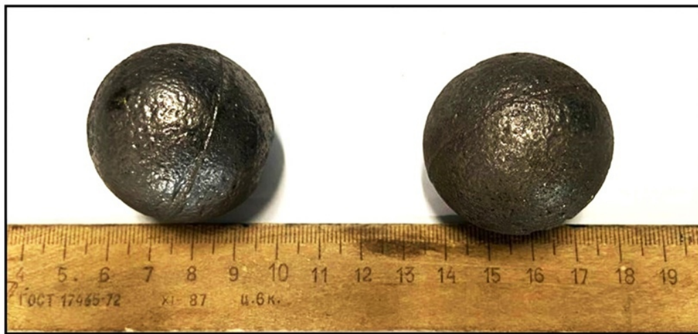
Рис. 3. Шары чугуные мелушие, выплавленные из побочного продукта вельцевания (металлизированных брэксов)
