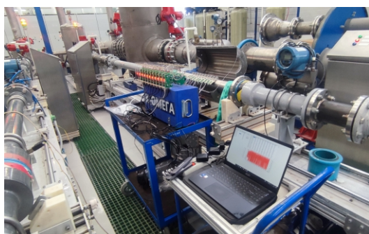
Рис. 1. Испытания прототипа накладного гидроакустического расходомера «К-Омега П-1»
