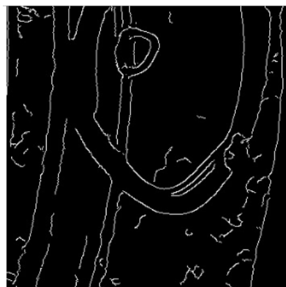
Рис. 4. Участок с дефектами после усиления контраста (сверху) и алгоритма выделения границ (снизу)
