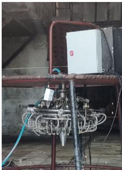
Рис. 1. Первый в РФ и мире функционирующий 16-камерный демонстратор двигательной установки с охлаждаемым центральным телом, работающий на топливной паре кислород-водород (аналогом является только проект США XRS-2200, прекративший свое развитие) успешно прошел многократные испытания на площадке индустриального партнера АО «НИИМаш», показал расчётную тягу и длительную работу
