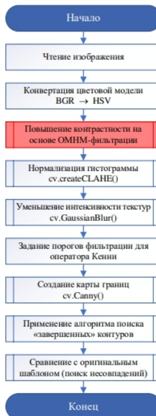
Рис. 3. Схема алгоритма сопоставления по контуру
