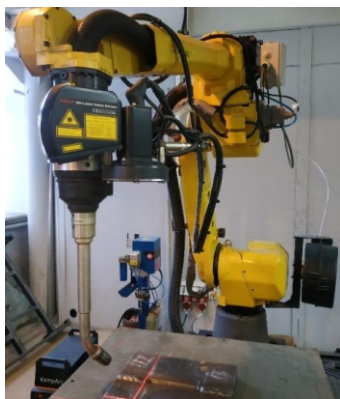
Рис. 1. Сварочный робот FANUC с установленной системой iRVision
