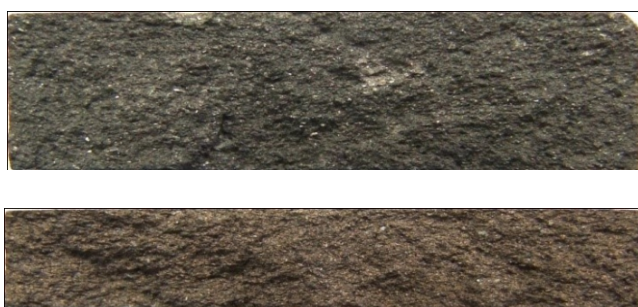
Рис. 2. Морфология изломов образцов: а – Графит+ Смола, б – Графит+ Смола+ Медь
